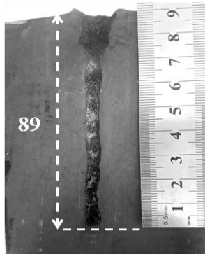
Hình 4.34. Mặt cắt dọc theo chiều sâu đâm xuyên của bia thép sau khi thử nổ.
