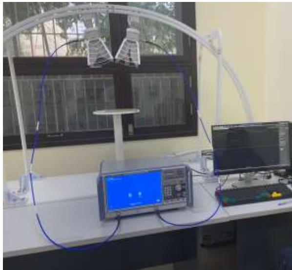
Hình 2.13. Quy đổi kết quả hệ số phản xạ thành độ hấp thụ.
