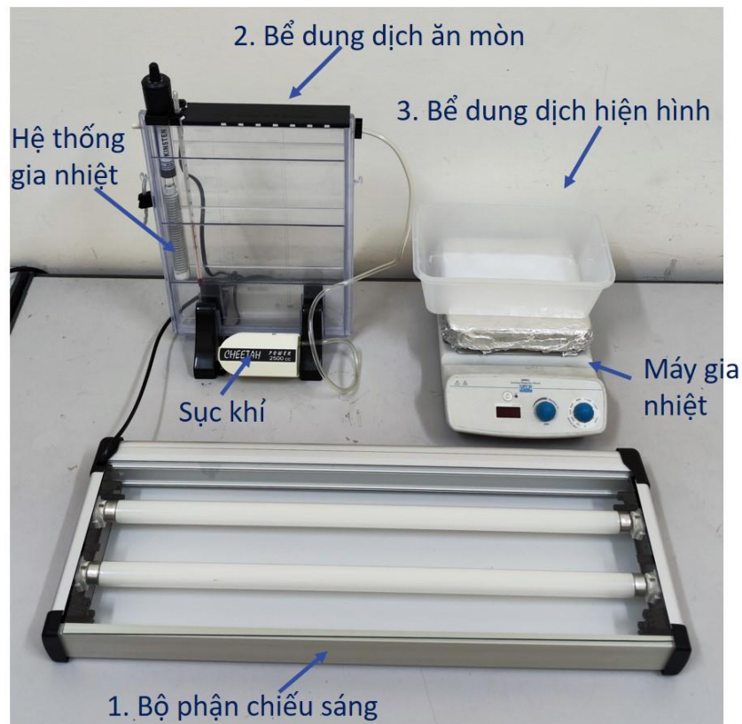
Hình 2.10. Hệ thiết bị quang khắc
