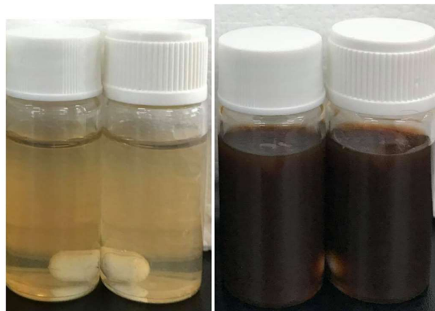
Hình 3.6. Tổng hợp nano bạc từ dịch chiết sâm Ngọc Linh trước (trái) và sau (phải) khi tổng hợp tại điều kiện thích hợp phản ứng: nồng độ 20 mM, nhiệt độ 90°C và thời gian 120 phút.
