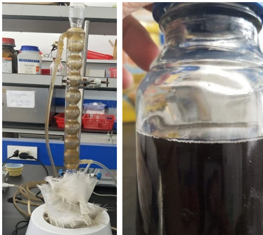
Hình 2.3. Hệ thống đun hồi lưu và dịch chiết sâm Ngọc Linh.
