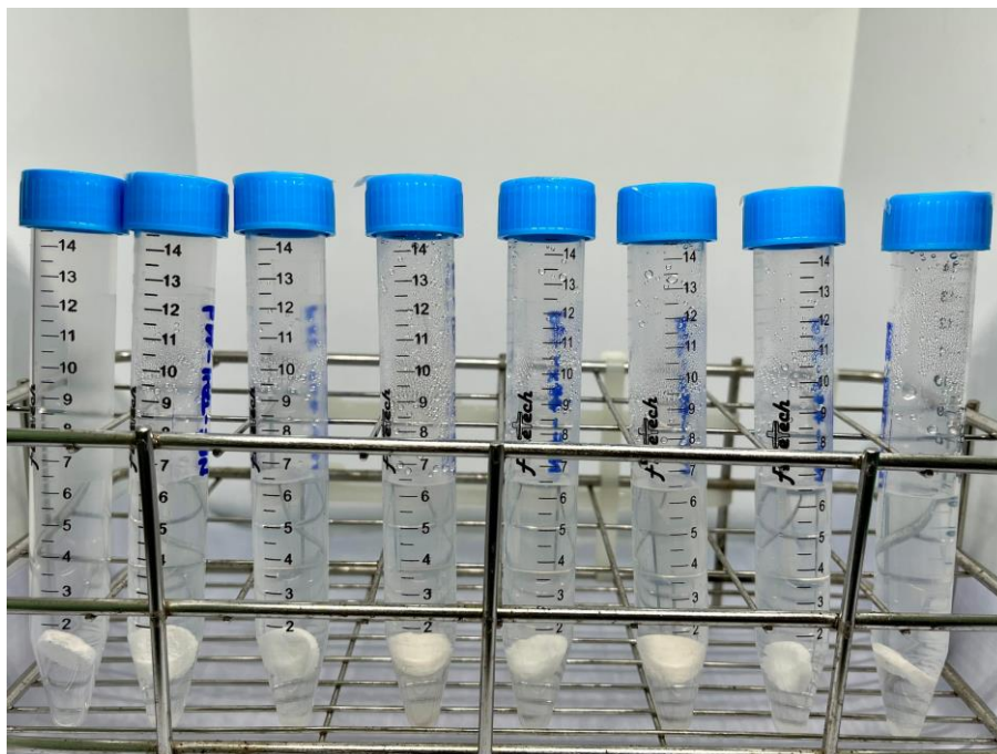
Hình 2.2 Mẫu thử nghiệm \alpha -HH ngâm trong dung dịch SBF ở các mốc thời gian xác định
