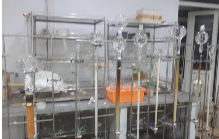
Hình 2.3. Sắc kí cột trong phòng thí nghiệm - Viện Hóa sinh biển.
