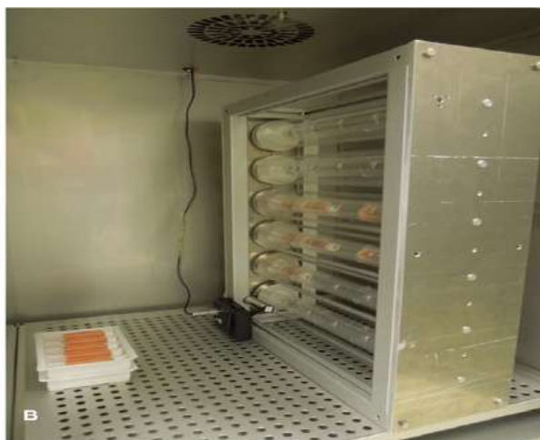
Hình 1.2. Mô hình 2-D clinostat [5]
