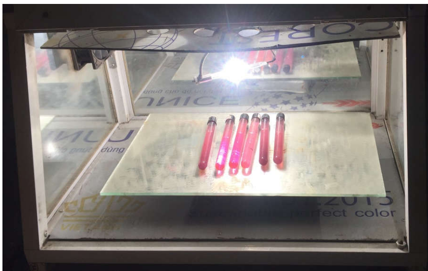
Hình 2.1. Tủ xúc tác quang hóa sử dụng đèn xenon AHD350
