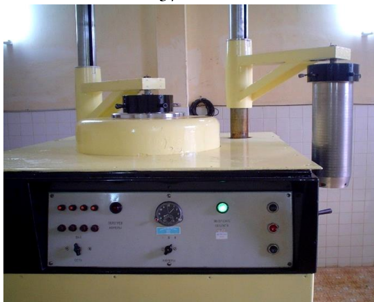
Hình 2.1 Thiết bị chiếu xạ gamma Co-60 (Isclédavachel)
