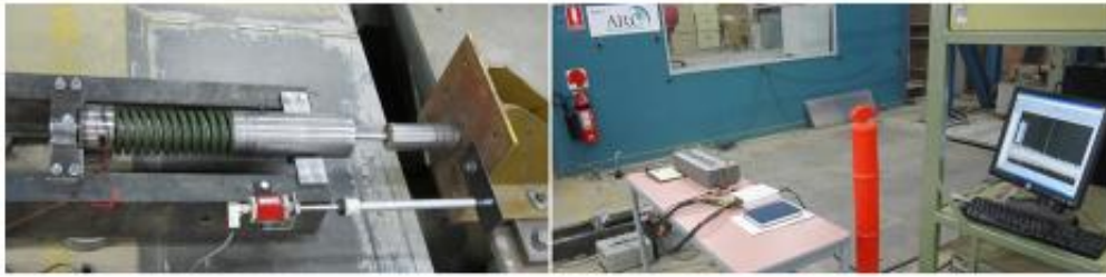
Hình 1.12 Hệ thống thí nghiệm thu thập năng lượng từ rung động nền đường
