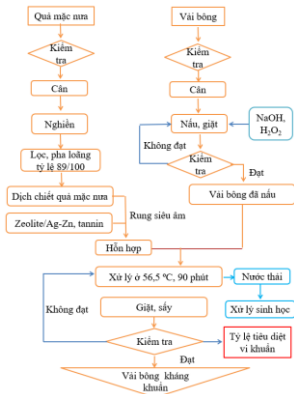
Hình 3.11. Sơ đồ quy trình xử lý vải bông kháng khuẩn bằng hỗn hợp
