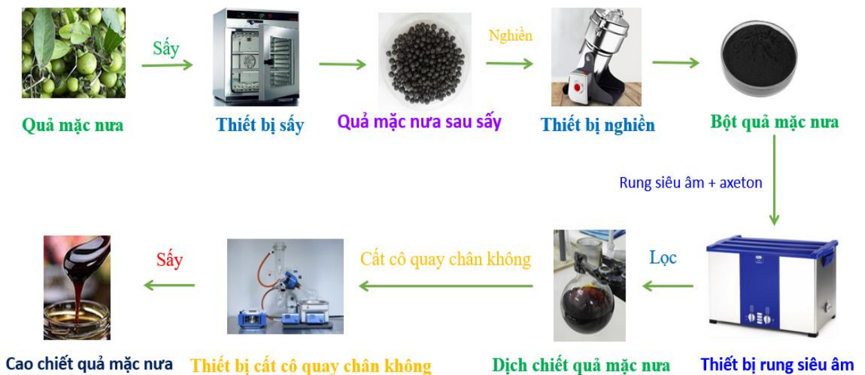
Hình 2.2. Sơ đồ quy trình chiết tách và tạo cao chiết từ quả mặc nưa
