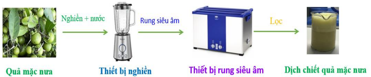
Hình 2.1. Sơ đồ quy trình chiết tách và tạo dịch chiết từ quả mặc nưa
