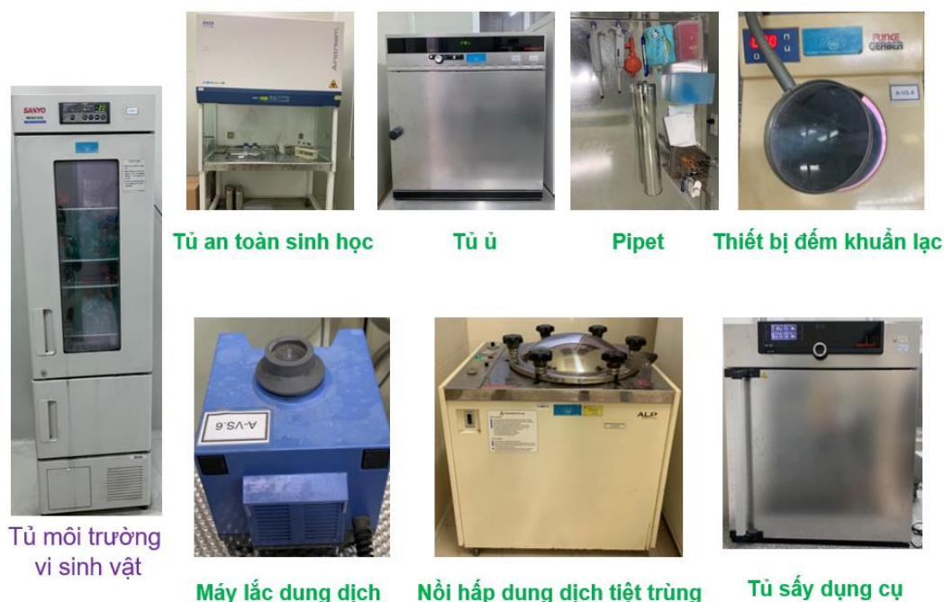
Hình 2.11. Dụng cụ và thiết bị xác định khả năng kháng khuẩn Tính toán phần trăm suy giảm vi khuẩn của mẫu vải bông thử nghiệm theo công thức:
