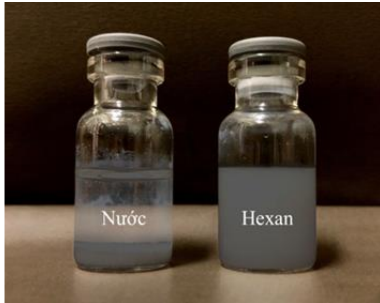
Hình 3.6. Hình ảnh các hạt nano lai ZA1 phân tán trong dung môi nước và hexane sau 3 giờ bảo quản
