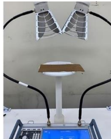
Hình 2.20. Ảnh hệ thiết bị phân tích mạng chuyên dùng để đo đặc tính chất điện từ của MA.
