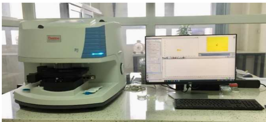
Hình 2.4. Máy quang phổ hồng ngoại \mu -FTIR
