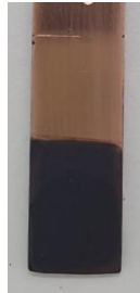
Hình 3.2. Hình ảnh SEM và hình ảnh quang học của điện cực Cu có cấu trúc nano hạt cầu (Cu-nanosphere).
