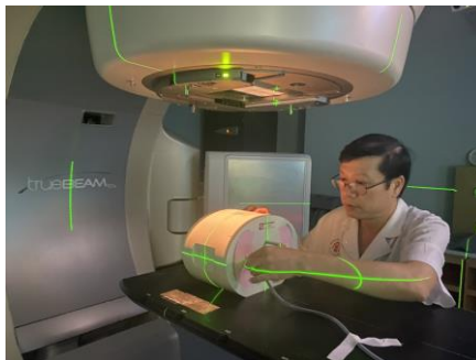
Hình 2.27. Thiết lập phantom lồng ngực trên máy gia tốc để đo liều
