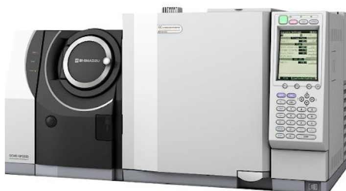
Hình 1.9: Thiết bị GC/MS tích hợp hệ thống AIQS
