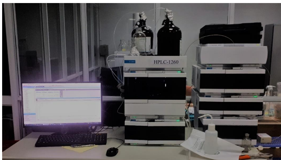
Hình 2.4. Hệ thống HPLC đặt trong phòng kỹ thuật – Viện Hóa sinh biển
