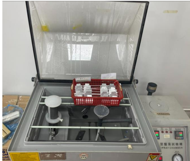
Hình 3.15. Mẫu anode thụ động sau 48 giờ phun muối
