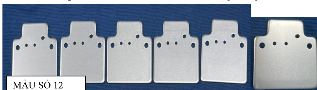
Hình 3.5. Sản phẩm nhôm sau khi anode thụ động trong dd mẫu số 12
