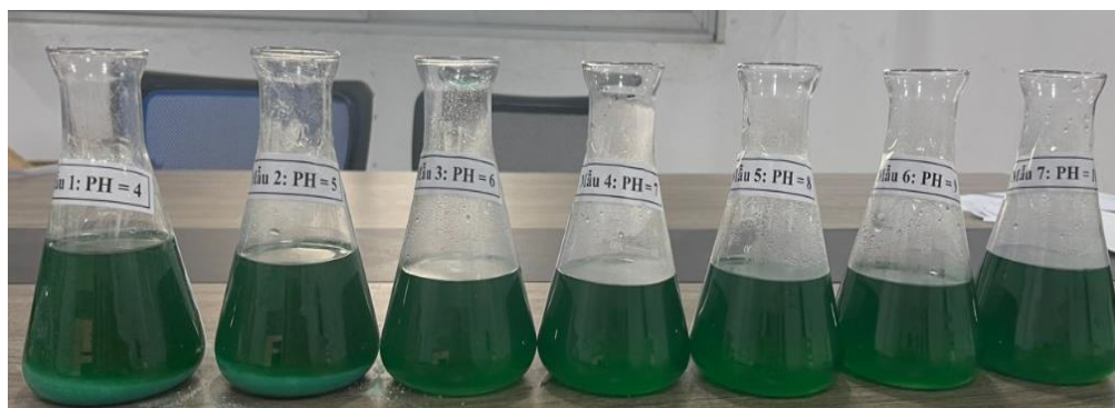
Hình 3.1. Hình ảnh kết tủa của nano silica ở pH = 4; pH = 5
