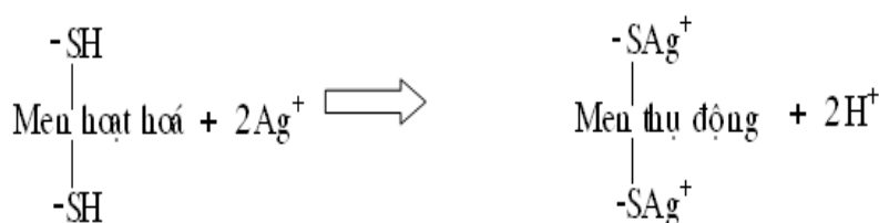
Hình 1. 5: Ion bạc vô hiệu hóa enzym chuyển hóa oxy của vi khuẩn
