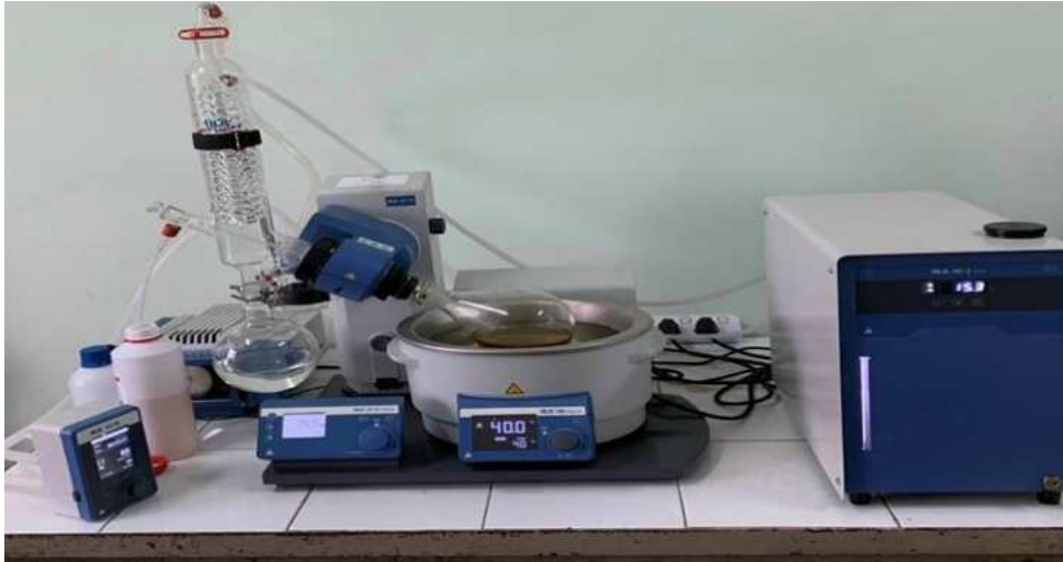
Hình 2. 1. Máy cô quay chân không dùng để cô quay dịch chiết từ vỏ quả lựu
