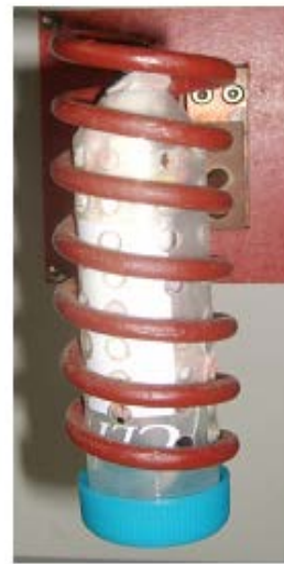
Hình 2.9. Bố trí thí nghiệm nhiệt từ trị in vivo trên thiết bị RDO, model HFI
