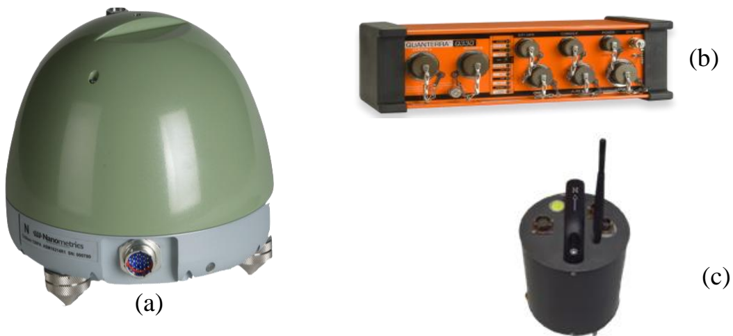
Hình 1.5. Thiết bị báo tin động đất thông thường. (a) Đầu đo; (b) Máy ghi; (c) Máy ghi tích hợp đầu đo.
