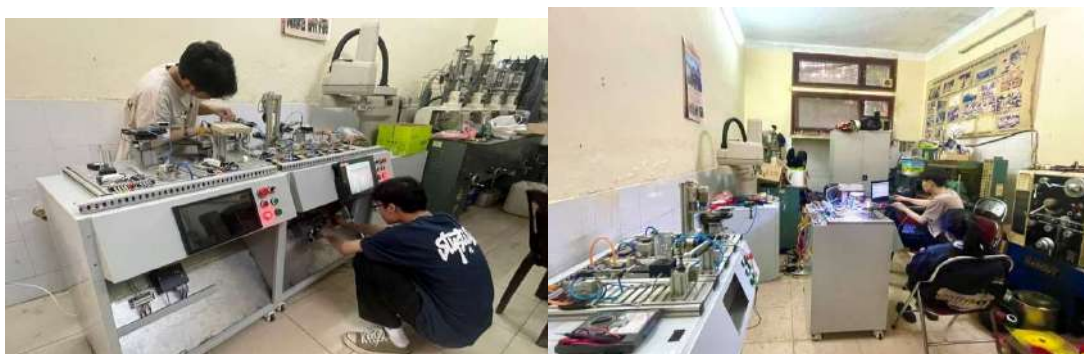
Hình PL. 8. Quá trình lắp đặt điện, PLC, HMI và lập trình hệ thống MPS
