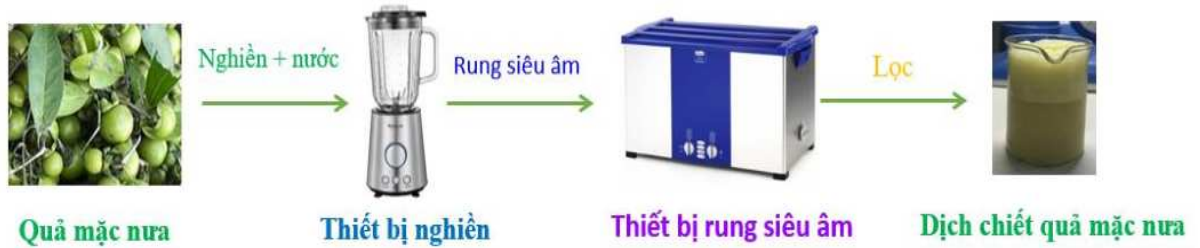
Hình 2.1. Sơ đồ quy trình chiết tách và tạo dịch chiết từ quả mặc nưa
