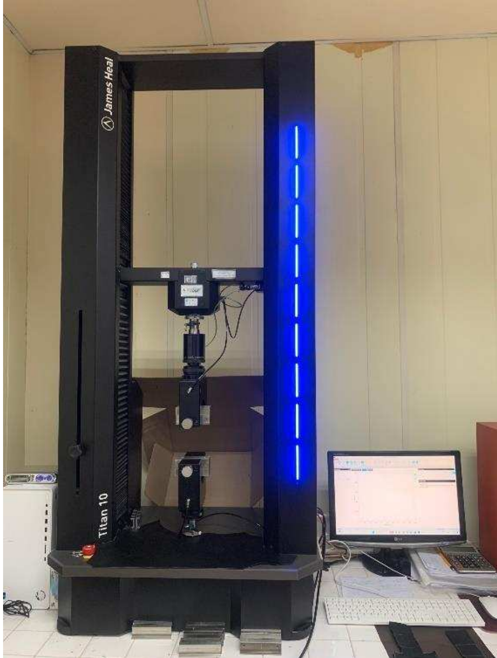
Hình 2.15. Thiết bị đo độ bền đứt và độ giãn dài khi đứt
