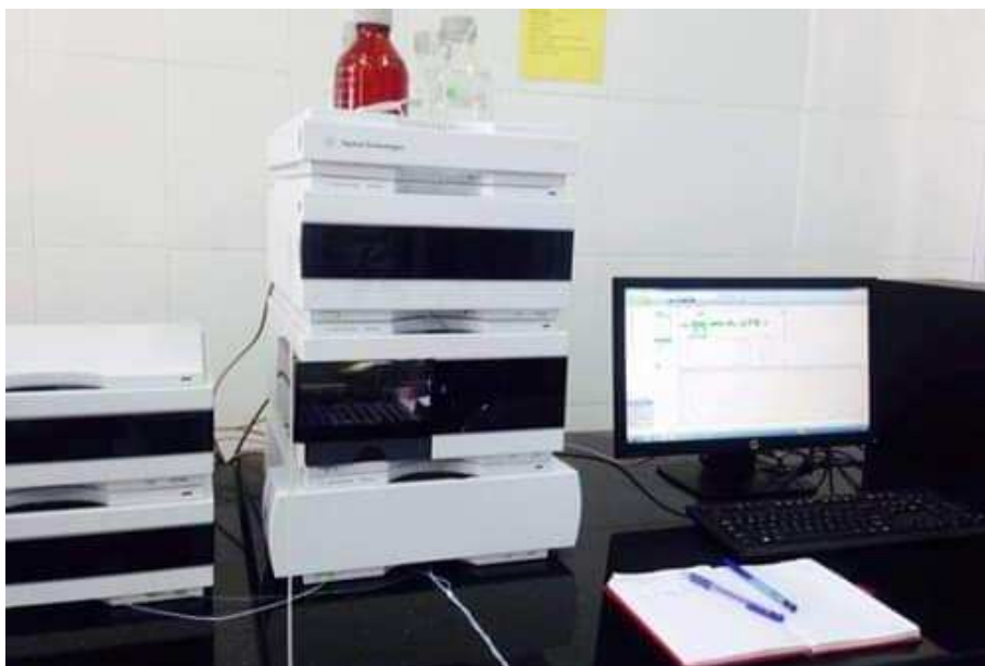
Hình 2.5. Thiết bị sắc ký lỏng hiệu năng cao (HPLC) Chromaster (Hitachi - Nhật Bản)
