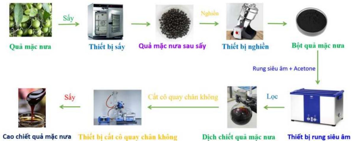
Hình 2.2. Sơ đồ quy trình chiết tách và tạo cao chiết từ quả mặc nưa
