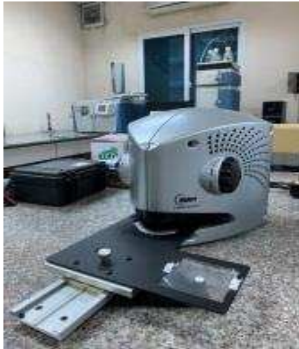
Hình 2.14. Máy quang phổ UV-2000F Labsphere (Mỹ) Giá trị UPF của từng mẫu vải được tính bằng công thức:
