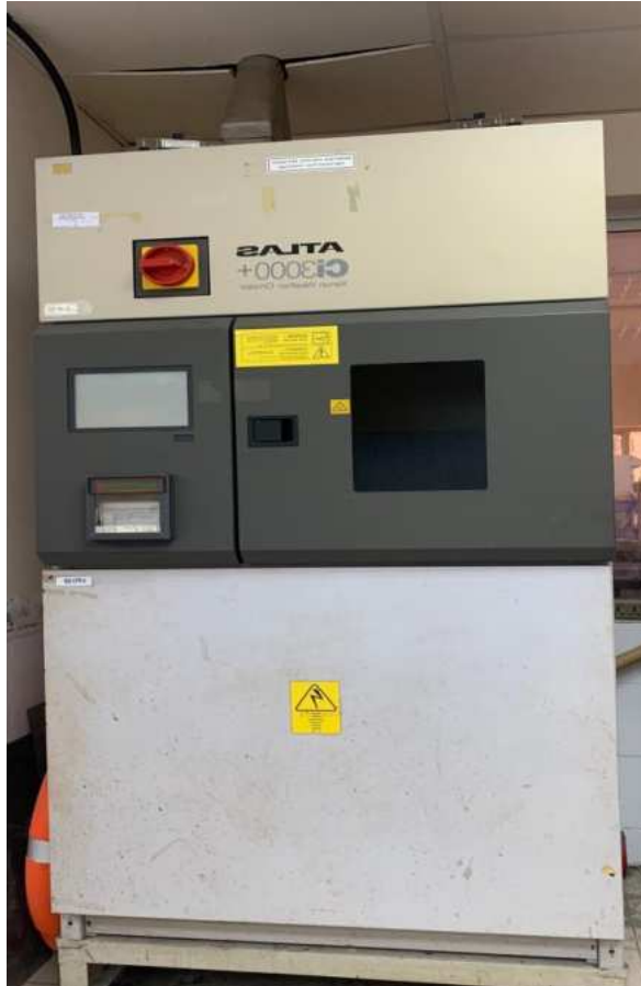
Hình 2.18. Thiết bị đo độ bền màu với ánh sáng atlas xenon weatherometer ci3000 (Mỹ)
