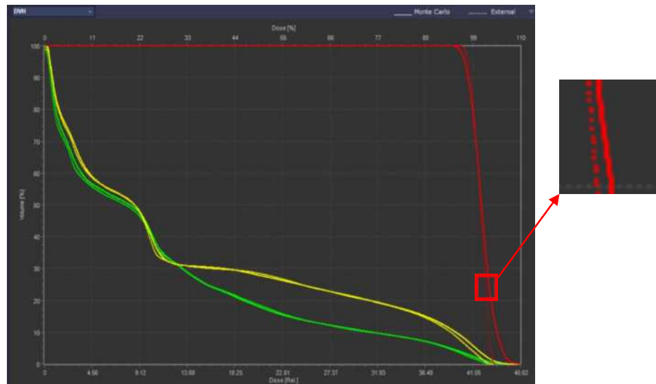
Hình 3.10. So sánh liều mô phỏng và lập kế hoạch trên biểu đồ liều-thể tích (DVH) (liều lập kế hoạch: nét đứt, liều mô phỏng: nét liền)
