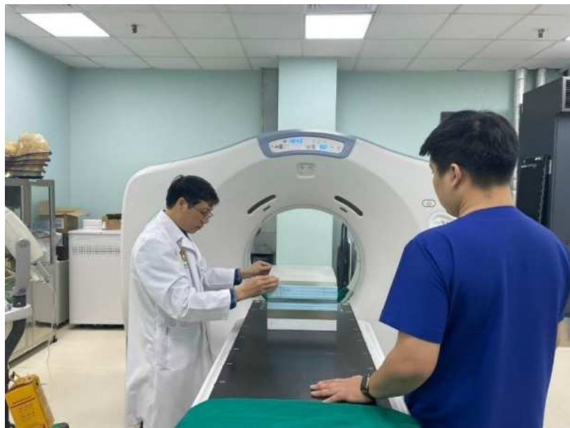
Hình 2.19. Chụp CT mô phỏng cho phantom mật độ không đồng nhất
