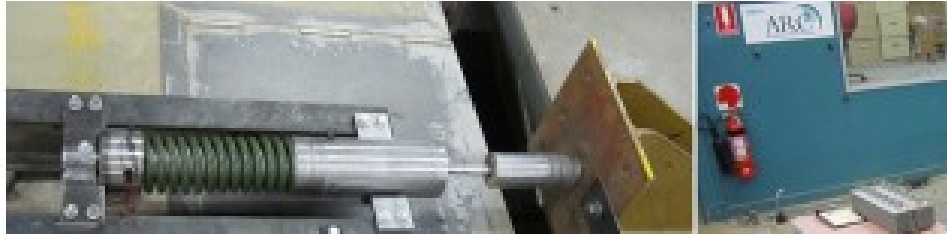
Hình 1.12 Hệ thống thí nghiệm thu thập năng lượng từ rung động nền đường, [73]
