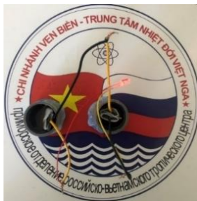
Hình 5.20. Hai siêu tụ điện ACCS/CNCS-2 ghép nối tiếp để thắp sáng bóng đèn led
