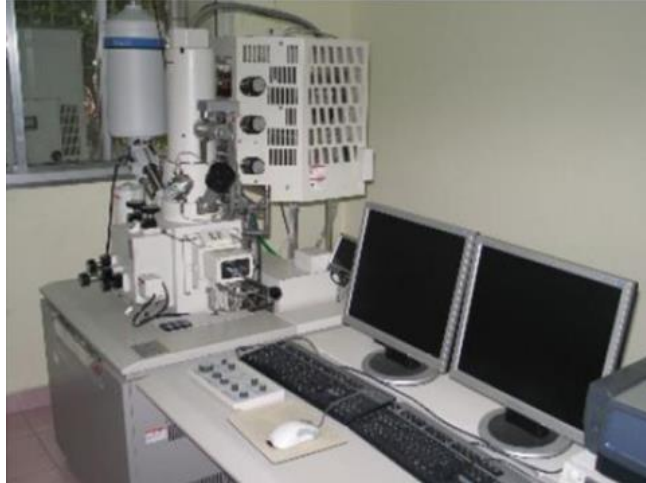
Hình 2.10. Kính hiển vi điện tử quét (SEM)
