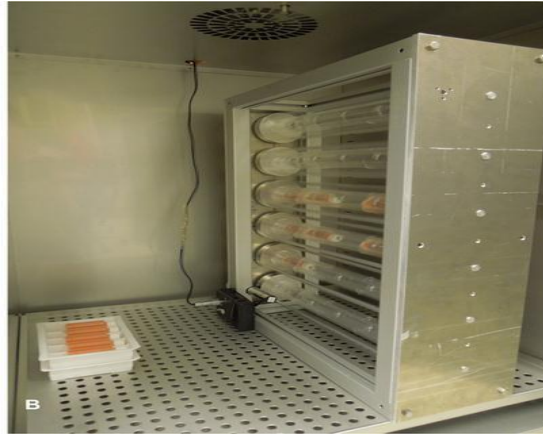
Hình 1.2. Mô hình 2-D clinostat [5]
