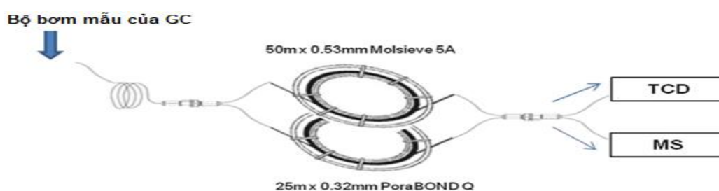
Hình 1.24. Thiết kế sắc ký để phân tích hydrogen và khí khác [133].
