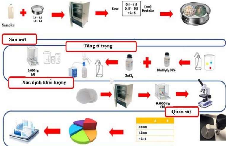
Hình 2.4. Quy trình phân tích xác định vi nhựa trong phòng thí nghiệm
