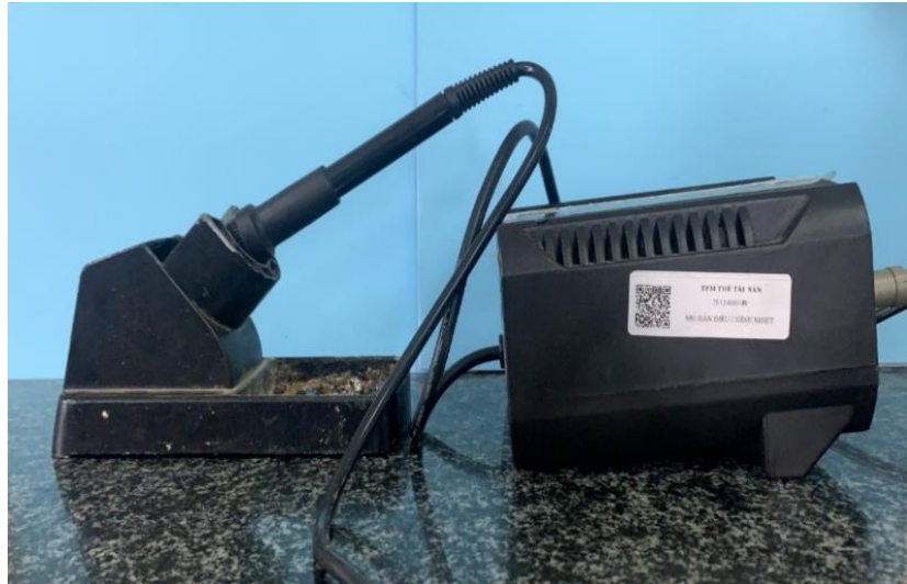
Hình 2.7. Hệ thiết bị dùng để hàn linh kiện điện tử vào bản mạch in.
