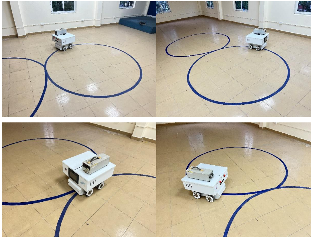
Hình 4.15 Thực nghiệm quỹ đạo hình số 8 trọng tâm thay đổi
