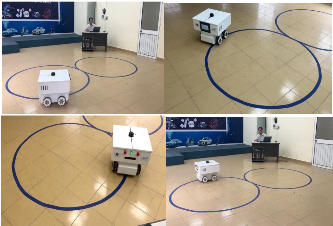
Hình 4.14 Thực nghiệm với quỹ đạo hình số 8 trọng tâm không đổi
