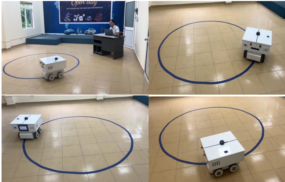
Hình 4.11 Thực nghiệm với quỹ đạo tròn trọng tâm không đổi
