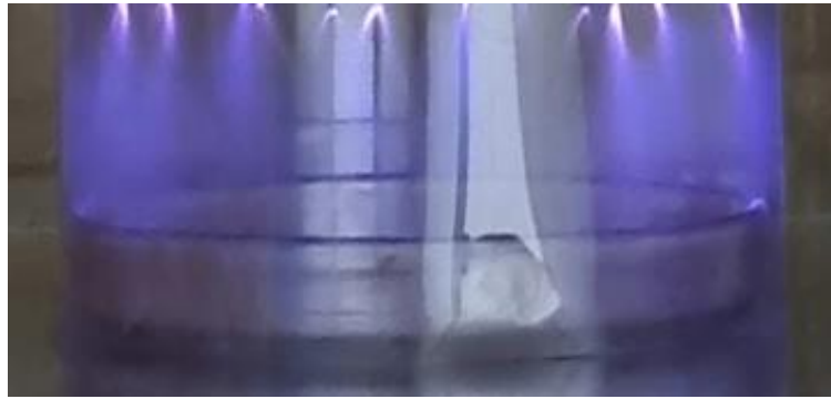
Hình 3. 2. Buồng phóng plasma trong quá trình vận hành
