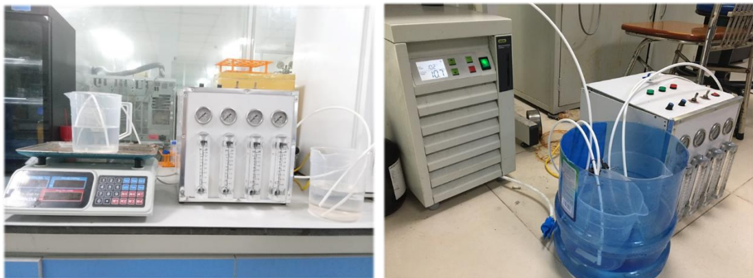
Hình 2.2. Hệ thống thực nghiệm màng FO quy mô phòng thí nghiệm
