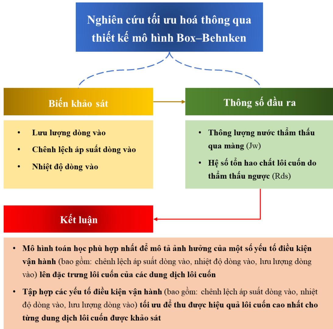
Hình 2.6. Các thông số biến khảo sát, thông số đầu ra, và nội dung kết luận của hệ thí nghiệm nghiên cứu tối ưu hoá các điều kiện vận hành của hệ thống màng FO
