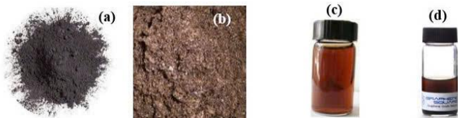
Hình 3.1. (a). Bột graphite, (b). Sản phẩm GO tổng hợp được, (c) Dung dịch GO trong nước cất, (d) Sản phẩm GO của Graphene Square Inc.
