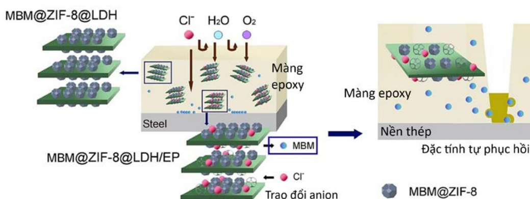
Hình 1.20. Sơ đồ mô tả cơ chế bảo vệ chống ăn mòn của lớp phủ epoxy dựa trên hiệu ứng rào cản, đặc tính tự phục hồi và khả năng trao đổi ion của chất độn composite MBM@ZIF-8@LDH [125]
