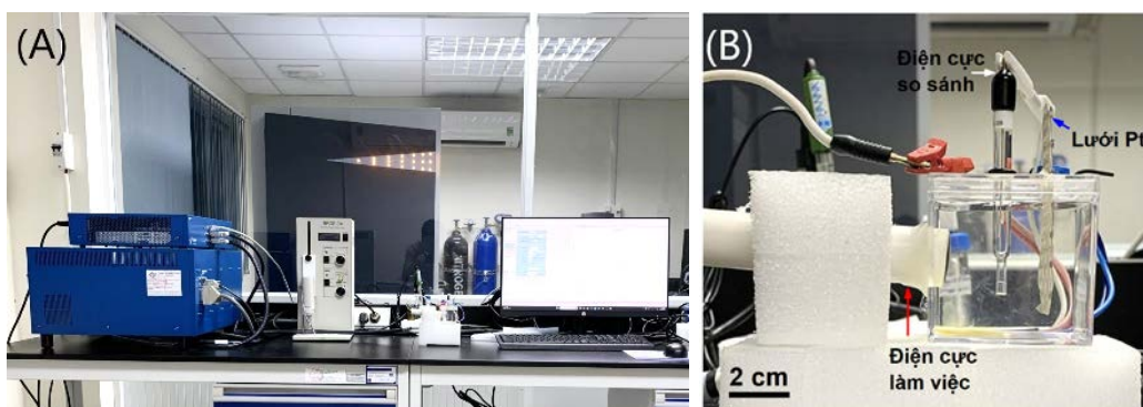
Hình 2.8. (A) Thiết bị điện hoá Biologic VSP và (B) hệ cell đo 3 điện cực
