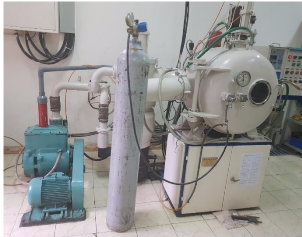
Hình 2.4. Ảnh thực của thiết bị phun băng nguội nhanh ZGK-1.
