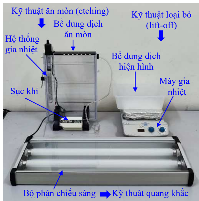
Hình 2.6. Hệ thiết bị quang khắc dùng trong chế tạo vật liệu biến hoá ở dải tần số MHz, GHz tại Viện Khoa học vật liệu.
