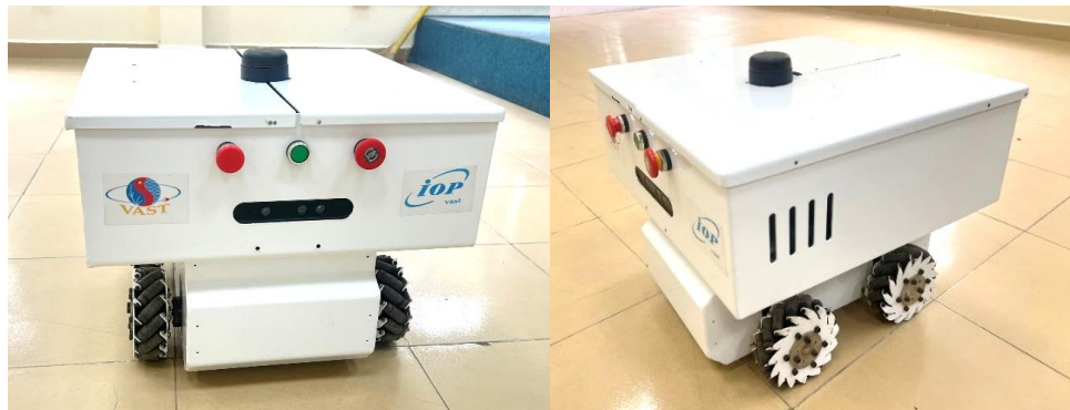
Hình 4.2 Mô hình cơ khí FMWR hoàn thiện
