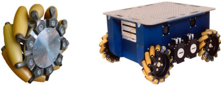
Hình 1.1 Mô hình robot tự hành bốn bánh xe mecanum
