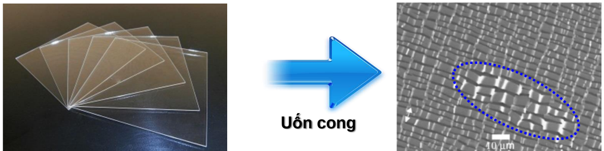
Hình 1.9. Ảnh SEM cho thấy màng ITO bị rạn vỡ sau khi uốn cong
