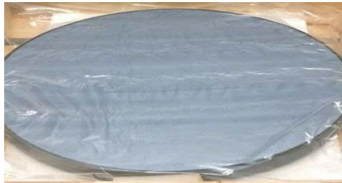
Hình 2.7. Gương cầu đường kính 60 cm sau khi mạ nhôm.
