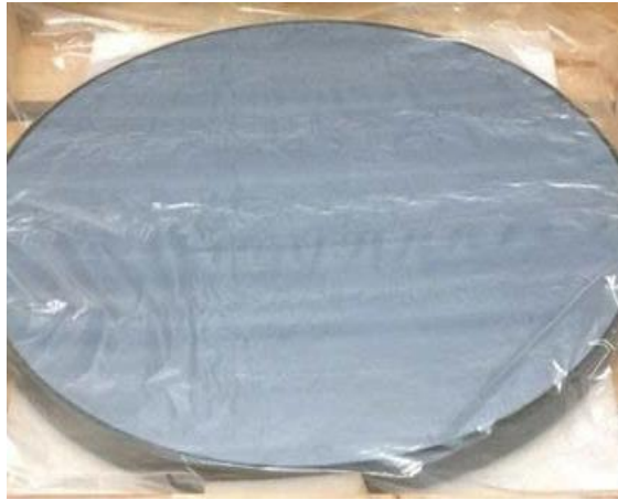
Hình 2.27. Gương cầu đường kính 60 cm tiêu cự 180 cm sau khi mạ nhôm.
