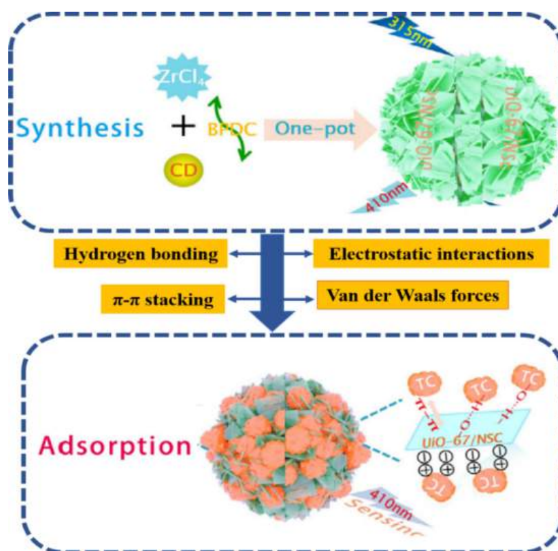
Hình 1. 13. Sơ đồ minh họa quá trình chế tạo UiO-67/NSC và cơ chế có thể của UiO-67/NSC trong việc loại bỏ TC [122].
