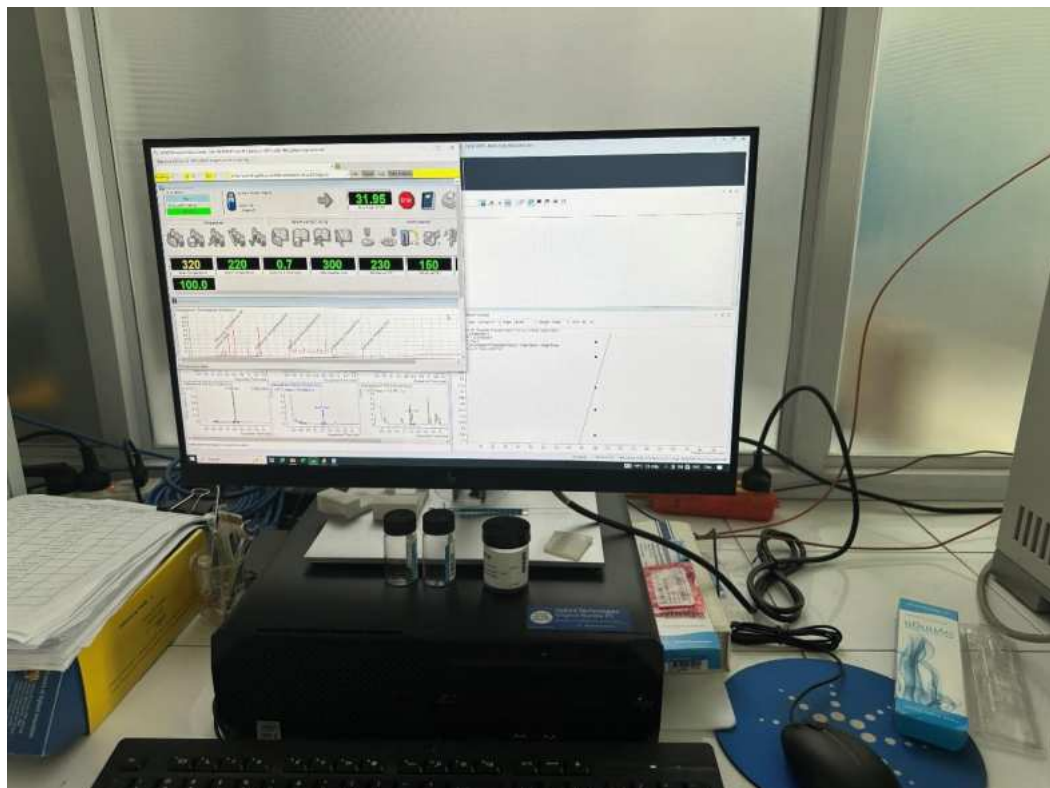
Hình PL4. Thiết bị Agilent 5977 GC/MS phân tích PAHs và OCPs
