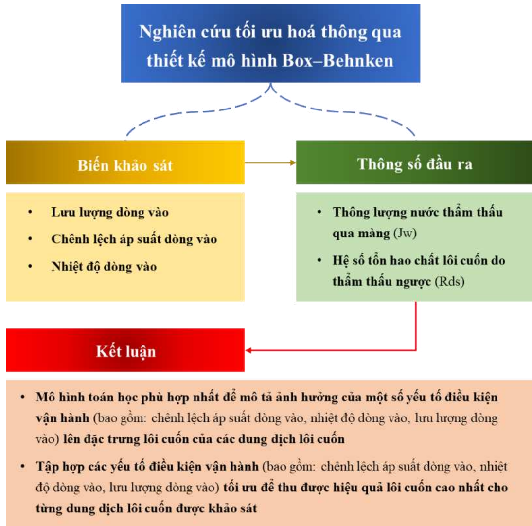
Hình 2.7. Các thông số biến khảo sát, thông số đầu ra, và nội dung kết luận của hệ thí nghiệm nghiên cứu tối ưu hoá các điều kiện vận hành của hệ thống màng FO
