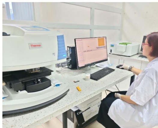
PL 1.1. Hệ thống máy FTIR-ATR (Ảnh chụp tại phòng thí nghiệm Viện Công nghệ môi trường – Học viện Khoa học và Công nghệ - Viện Hàn lâm Khoa học và Công nghệ Việt Nam)
