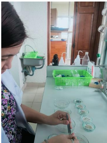
PL 4.2. Vi nhựa được phân loại màu sắc, hình dạng bằng nhíp
