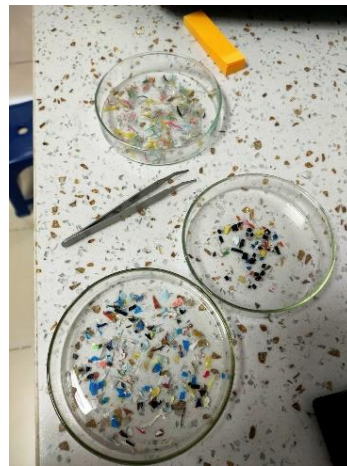
PL 4.2. Vi nhựa được phân loại màu sắc, hình dạng bằng nhíp
