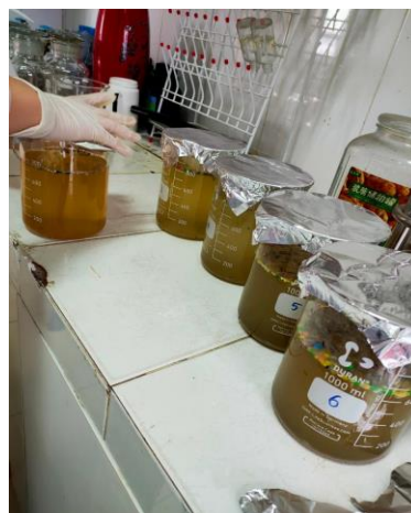
PL 3.3. Công đoạn oxy hóa để loại bỏ các chất hữu cơ (Ảnh chụp tại phòng thí nghiệm Viện Công nghệ môi trường – Học viện Khoa học và Công nghệ - Viện Hàn lâm Khoa học và Công nghệ Việt Nam)
