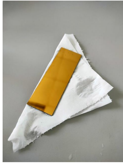
PI 4.4. Chuẩn bị gương vàng để soi vi nhựa bằng máy quang phổ FTIR
