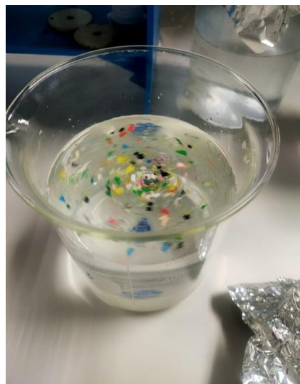
PL 3.5. Giai đoạn cho dung dịch NaCl vào nhằm tách tỉ trọng, vì nhựa nổi trên bề mặt, khoáng vật và kim loại chìm xuống đáy cốc (Ảnh chụp tại phòng thí nghiệm Nation Lab – IECES)
