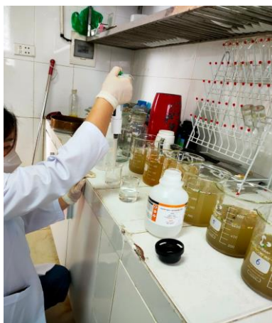
PL 3.3. Công đoạn oxy hóa để loại bỏ các chất hữu cơ (Ảnh chụp tại phòng thí nghiệm Viện Công nghệ môi trường – Học viện Khoa học và Công nghệ - Viện Hàn lâm Khoa học và Công nghệ Việt Nam)
