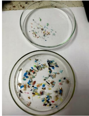
PL 4.1. Vi nhựa được phát hiện trong mẫu nước với nhiều hình dạng và kích thước khác nhau
