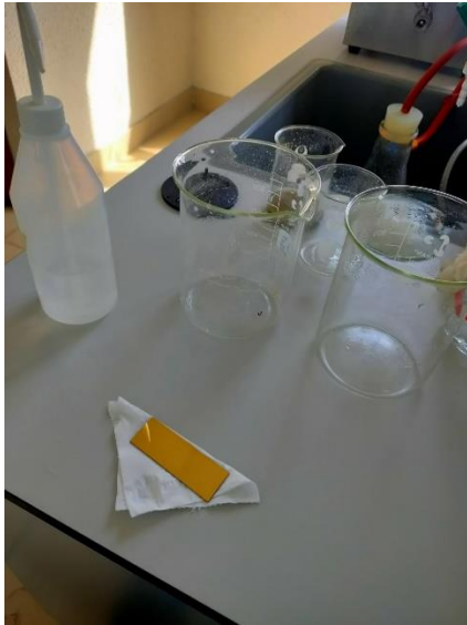
PI 4.4. Chuẩn bị gương vàng để soi vi nhựa bằng máy quang phổ FTIR
