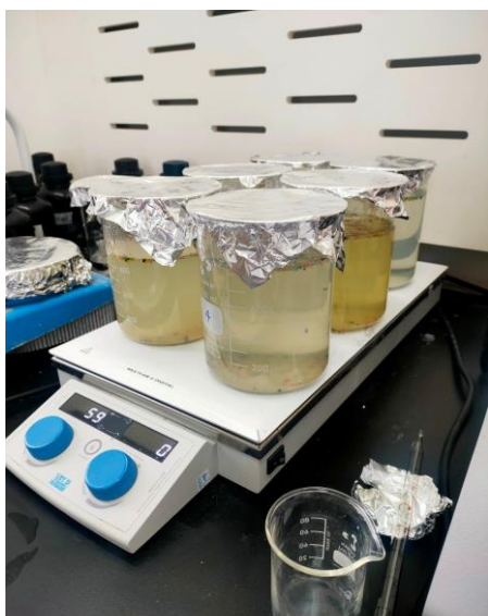
PL 3.4. Giai đoạn dung dịch mẫu dần trở nên trong hơn, oxy hóa hoàn toàn các hợp chất hữu cơ (Ảnh chụp tại phòng thí nghiệm Viện Công nghệ môi trường – Học viện Khoa học và Công nghệ - Viện Hàn lâm Khoa học và Công nghệ Việt Nam)
