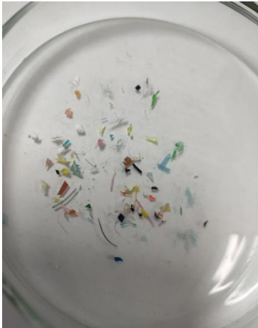
PL 4.1. Vi nhựa được phát hiện trong mẫu nước với nhiều hình dạng và kích thước khác nhau
